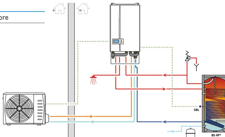
\* Il serpentino di scambio nel bollitore deve avere un superficie di almeno 0,5 m<sup>2</sup> moltiplicato per i kW termici della pompa di calore.
